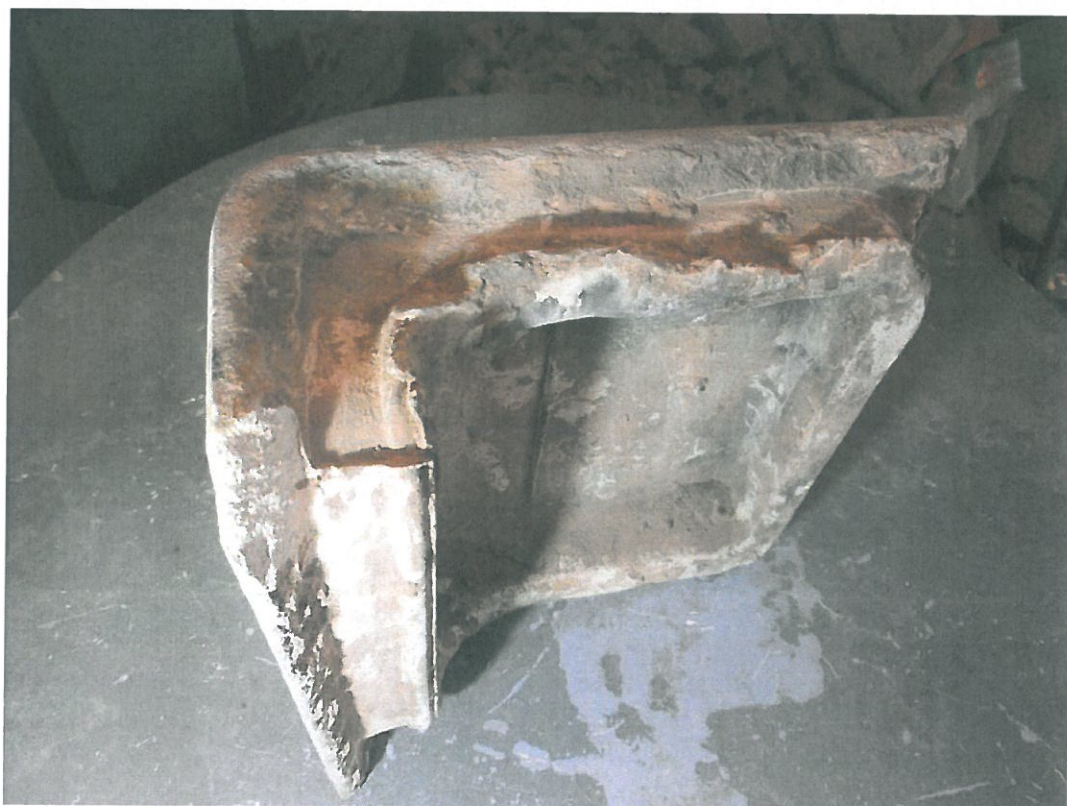
Fot. nr 64, 65 – Kossakówka – Plac Kossaka 4, Kraków. Kafel narożnikowy pieca nr 7 od strony lica i odwrocia. Widoczna charakterystyczna cecha – wyjątkowo duży promień zaokrąglenia narożnika. Od strony odwrocia widoczne ślady formy – kafel był odlewany w całości z białej mieszanki gliny. fot. Andrzej Karbowski – czerwiec 2021 r.
