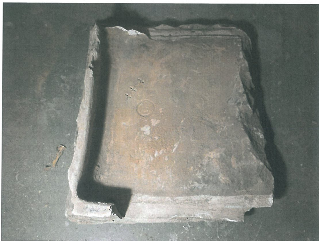
Fot. nr 70, 71 – Kossakówka – Plac Kossaka 4, Kraków. Seledynowy, bogato zdobiony jeden z kilku zachowanych kafli prawdopodobnie z końca XIX wieku. Widok od strony lica i odwrocia. Odcisnięte na odwrociu kółko i trzy krzyżyki oznaczają zapewne typ kafła, a nie wytwórnię.
