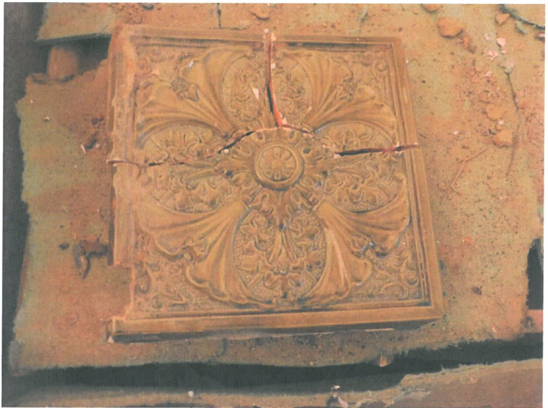
Fot. nr 5, 6 – Kossakówka – Plac Kossaka 4, Kraków. Sposób pakowania kafli eklektycznych pieca nr 1 w skrzyni oraz na dolnym zdjęciu kafel popękany na skutek nadmiernego obciążenia płasko leżącymi kafłami górnych warstw. W dolnej krawędzi popękanego kafla widoczne wtórne, prostokątne wycięcie. fot. Andrzej Karbowski – styczeń 2021 r.
